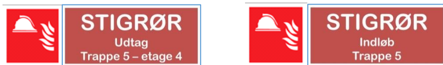
Figur ##: Eksempel på skilte til stigrør, indløb og udtag ved bygning med flere stigrør
