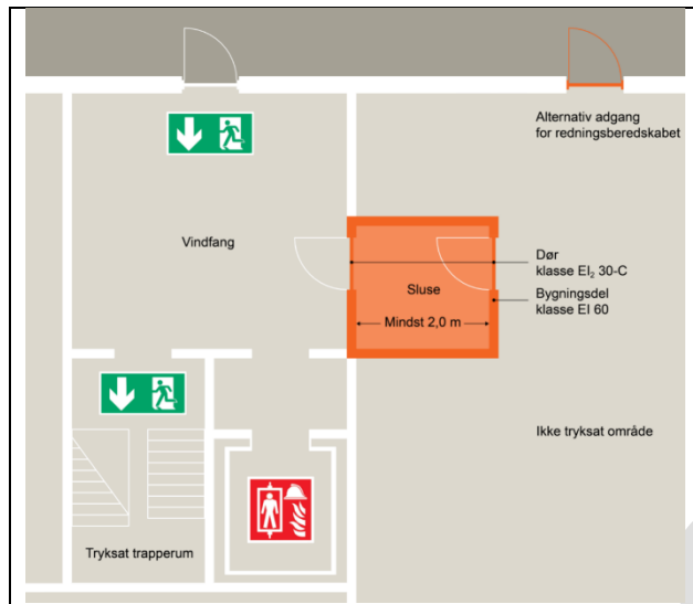
Figur ##: Sluse til vindfang for ATA-anlæg
